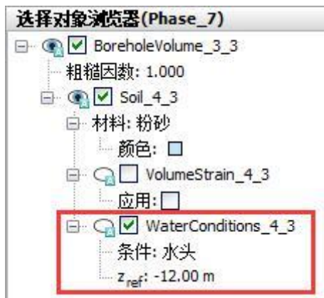
图 19 设置坑底水头
